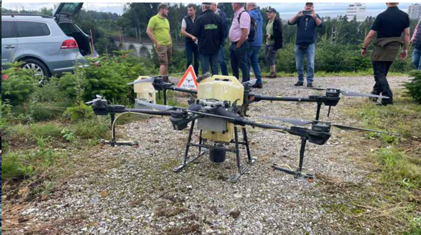
Sprøjtning hos familien Sepp Germann foregik med en stor drone, der efter den indledende GPS-programmering, sprøjtede indtil tanken var tom eller batteriet skulle lades op.
